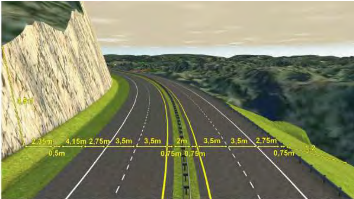
Figur 1-3 Tverrprofil veiklasse H3
