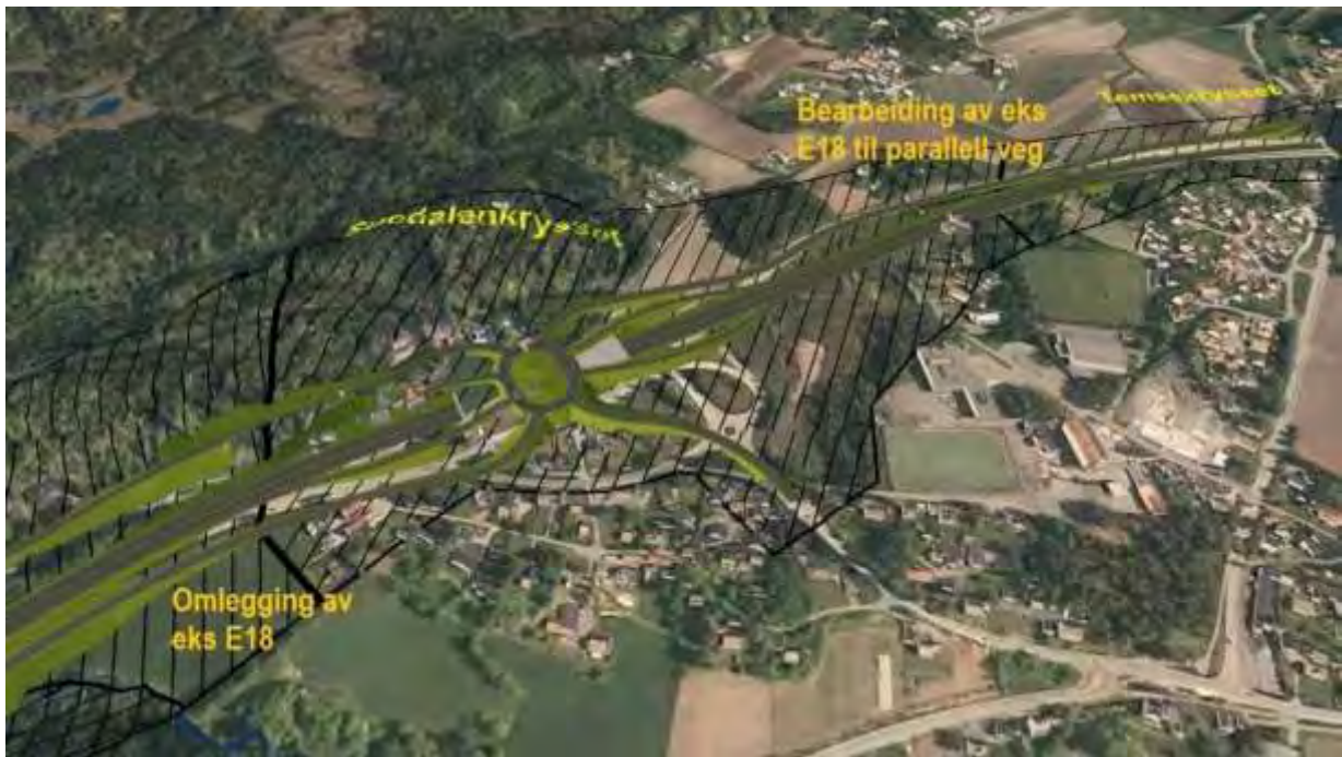
7-12 Eksempel på kryssutforming ved Spedalen.
