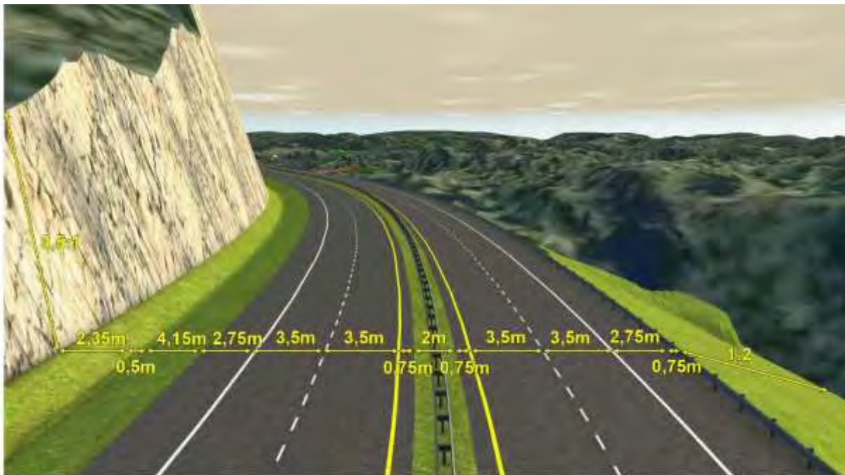
Figur 6-1 Tverrprofil veiklasse H3
