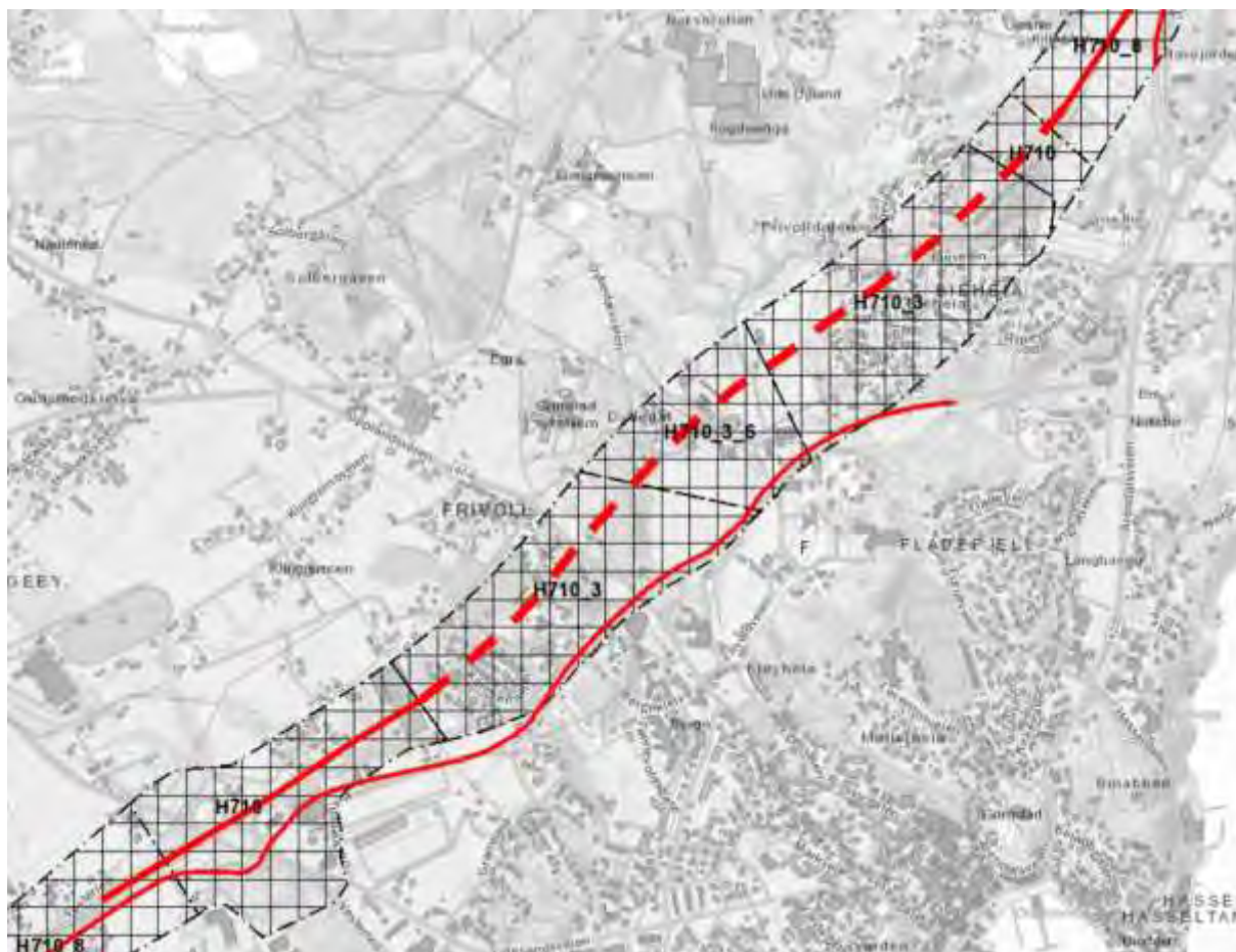
8-28 Kartutsnittet viser båndlagt område gjennom Grimstad sentrum, med stiplet eksempellinje for fjelltunnel under Frivoldalen. Tynnere rød linje viser lokalvei.
