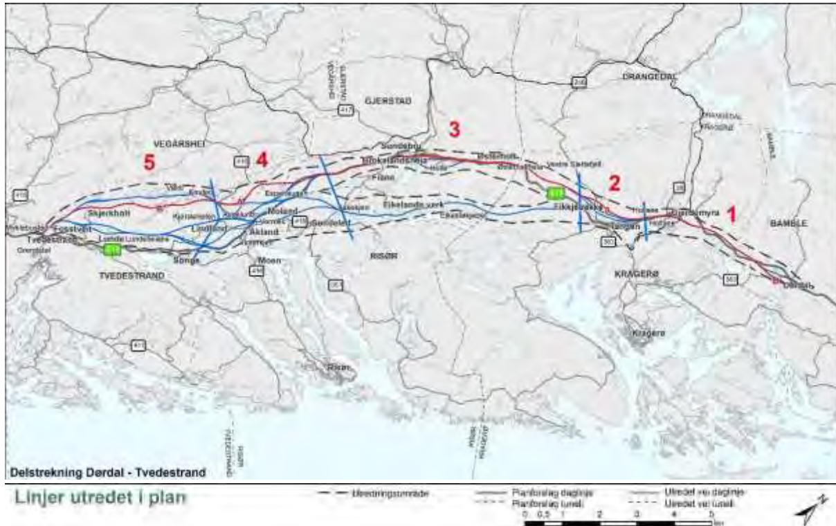
Figur 9-1 Eksempelveilinje som ligger til grunn for planforslaget for Dørdal-Tvedestrand er markert med rød linje, de utredede eksempellinjene er markert med blå linjer. Dagens E18 er vist med grå linje.
