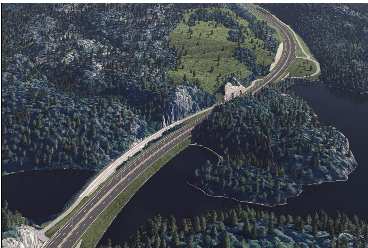
Figur 3-38: Utfylling i Stidalskilen og masselager Vestre Huldalsstranda, sett fra vest. (Kilde: Sweco)
